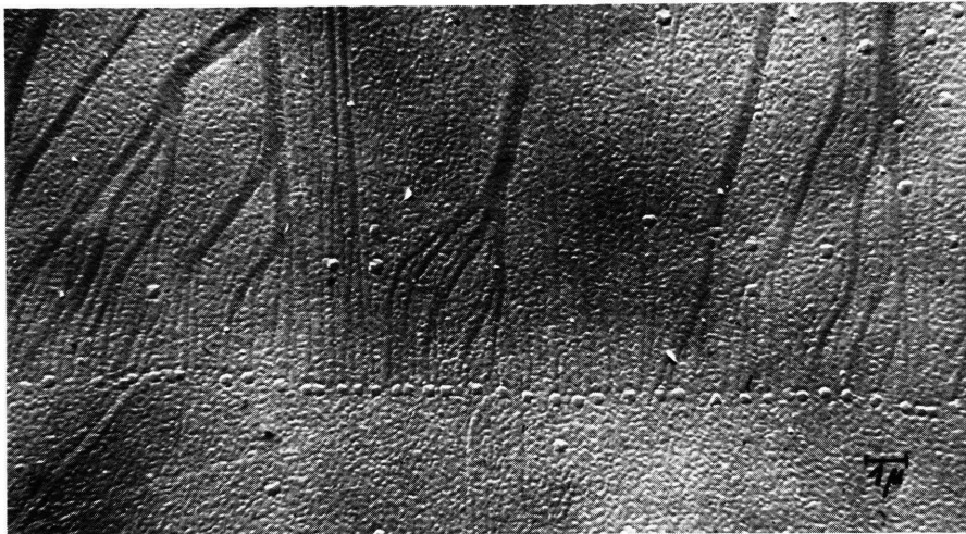
Abb. 1. Feinkorngrenze ( twist-boundary ) auf einer Steinsalz-Spaltfläche (4800-fach).
