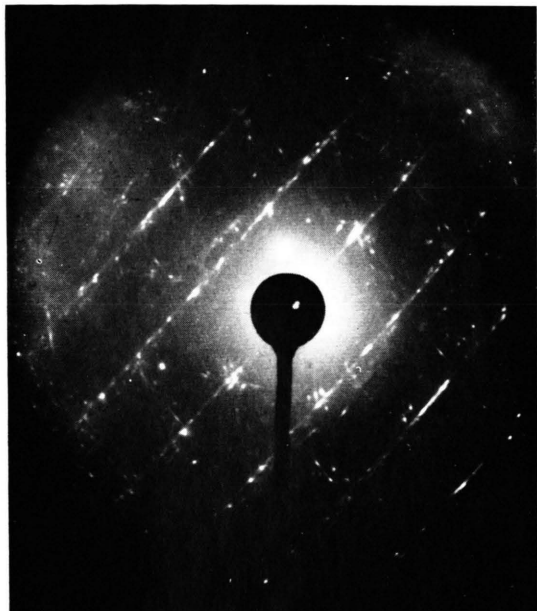
Abb. 1. Elektronenbeugungstexturdiagramm paralleler CuO-Nadeln (oxydiert 15 Stdn. bei 200 °C im Sauerstoffstrom unter HCl-Zusatz).
