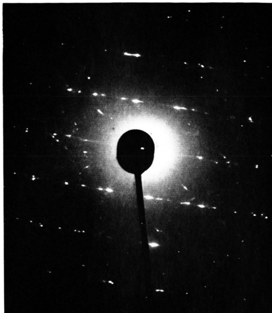
Abb. 2. Elektronenbeugungsdiagramm vorwiegend von einer CuO-Nadel (oxydiert 9 Stdn. bei 240 °C im Sauerstoffstrom unter HCl-Zusatz).
